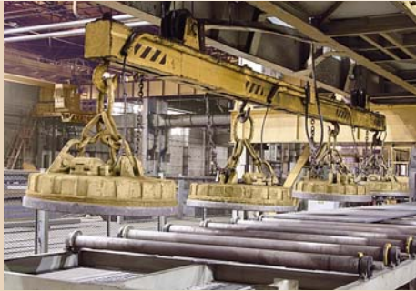
Магнитоукладчик листопрямых вальцев УБР-40. A magnet layer of rolls' plate straightening UBR-40.
