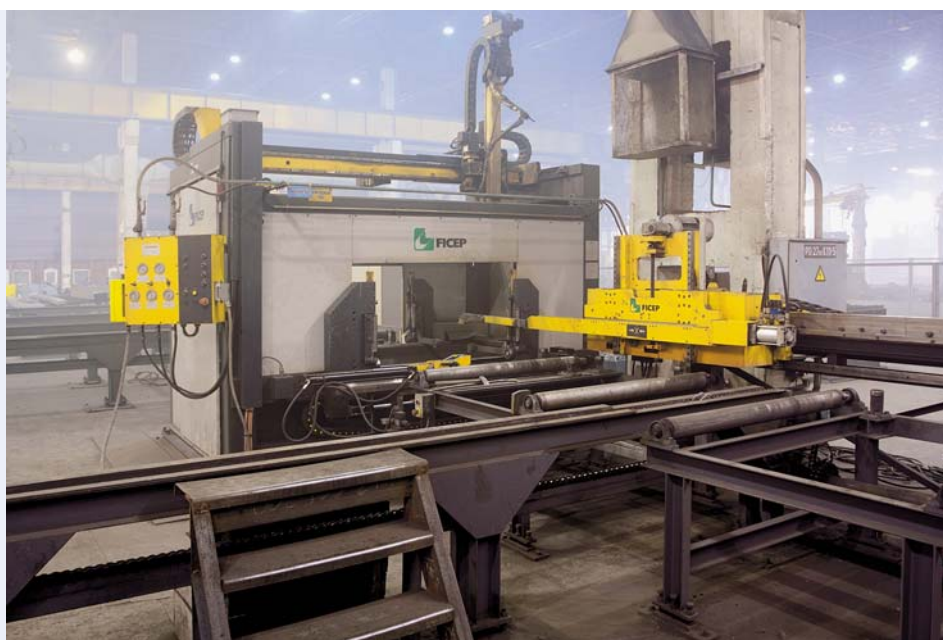
Автоматическая линия термической резки сортового проката Ficer1261-TT. Ficer1261-TT drilling and thermal cutting of sorted roll stock automatic line.
