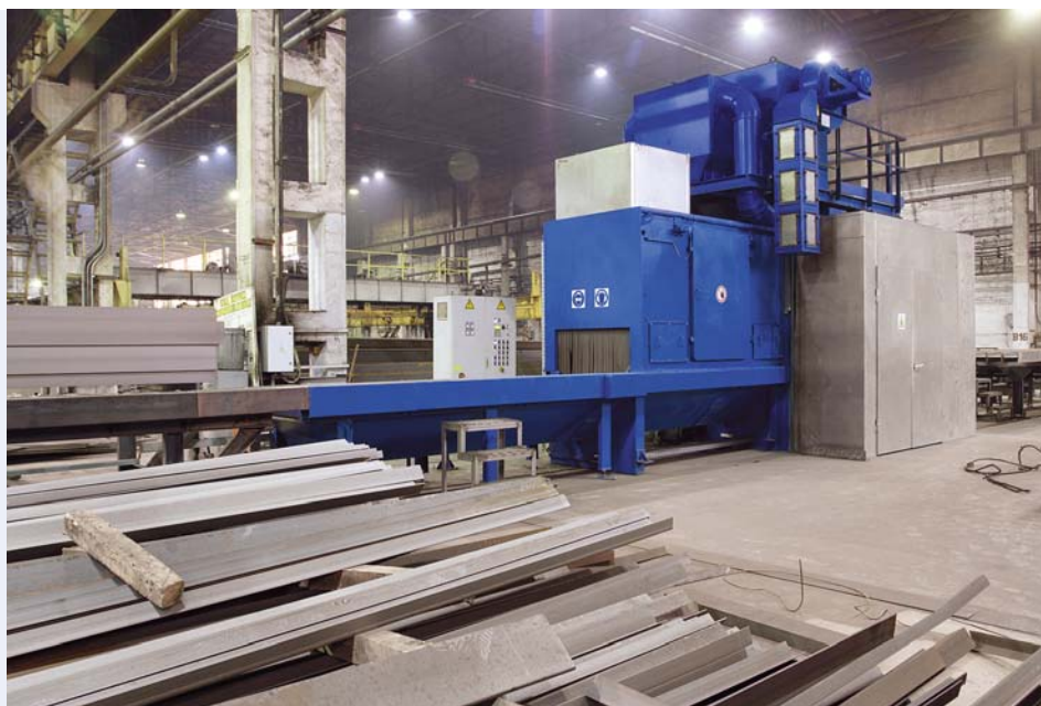
Дробеметная установка Schlick 1000. Schlick 1000 shotblast unit.
