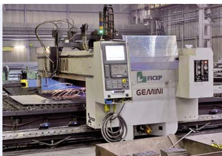
Автоматическая линия термической резки и высокоскоростного сверления листа Gemini-254 PG.
