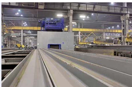
Дробеметная установка Schlick 1000. Schlick 1000 shotblast unit.
