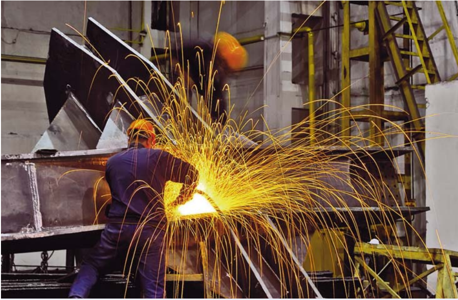
Сварка металлоконструкций для Центрального олимпийского стадиона в Сочи. Фото 2011 г. Welding of the constructions for a Central stadium in Sochi. Photo of 2011.
