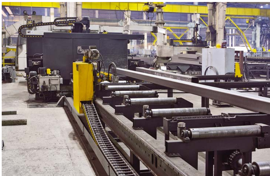
Автоматическая линия сверления и резки Ficor DNB 603. Ficor DNB 603 drilling and cutting automatic production line.
