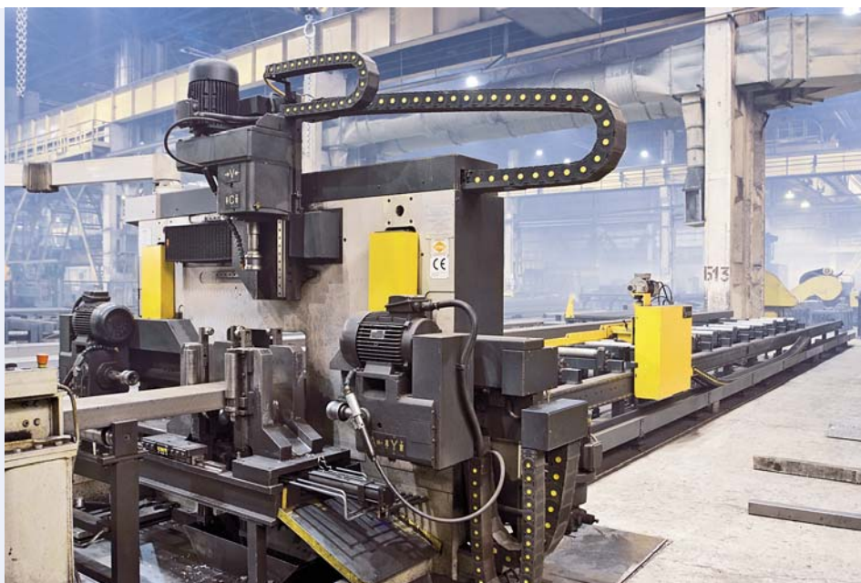
Автоматическая линия сверления и резки Ficor DNB 603. Ficor DNB 603 drilling and cutting automatic production line.
