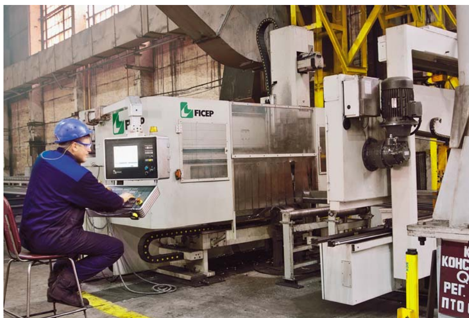
Автоматическая линия сверления и механической резки Ficep DZB 1001.
