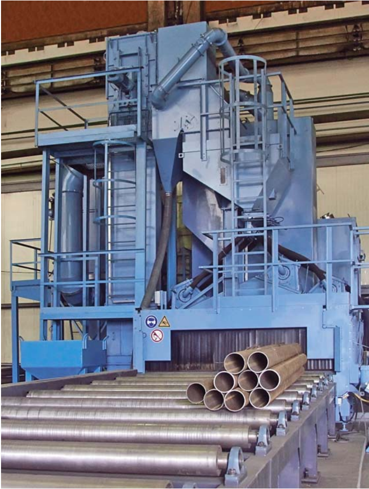
Дробеструйная камера. A shot blasting chamber.
