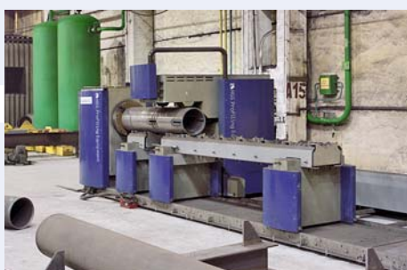
Установка для термической фасонной резки труб HGG PG 600. HGG PG 600 unit for thermal shape cutting of pipes.
