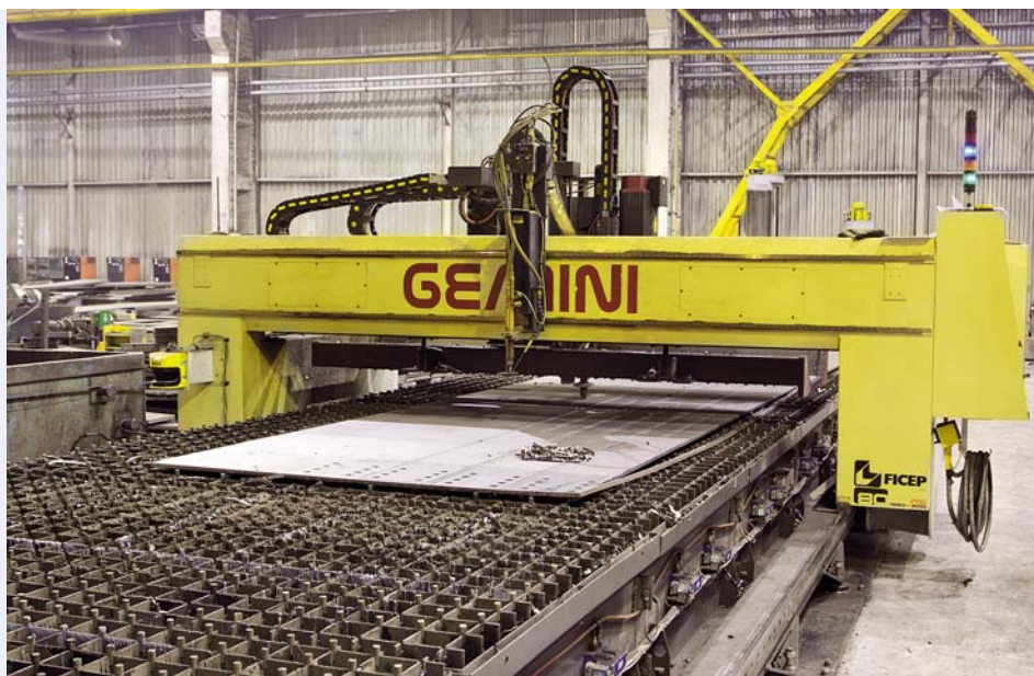
Автоматическая линия термической резки и высокоскоростного сверления листа Gemini-254 PG.
