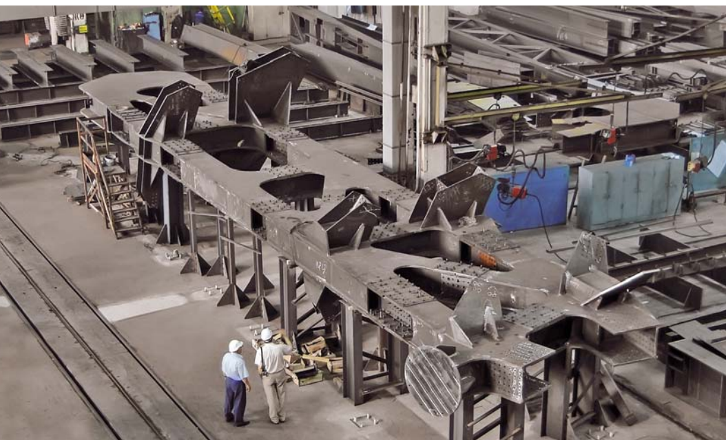
Контрольная сборка конструкций для стадиона в Сочи. Фото 2011 г. Control assembly of the constructions for a Stadium in Sochi. Photo of 2011.
