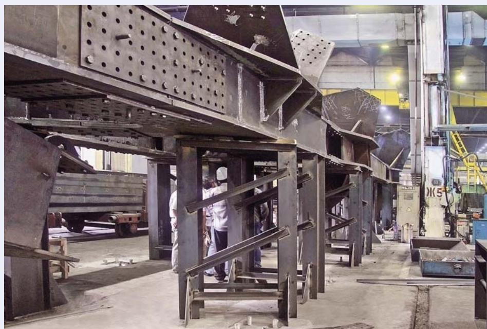
Контрольная сборка конструкций для стадиона в Сочи. Фото 2011 г. Control assembly of the constructions for a Stadium in Sochi. Photo of 2011.
