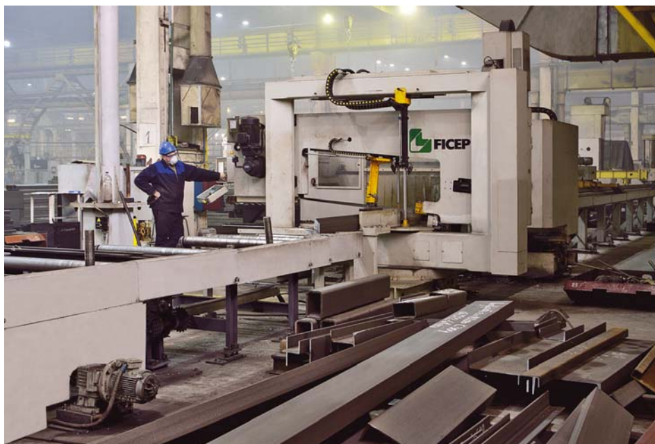
Автоматическая линия сверления и механической резки Ficep DZB 1001.
